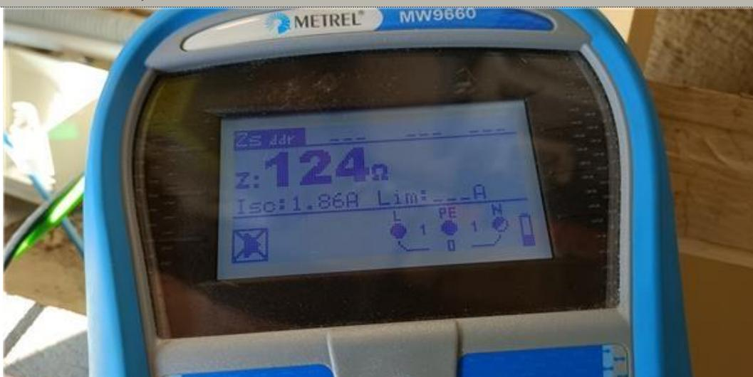
**Description :** La valeur de la résistance de la PRISE DE TERRE n'est pas adaptée au courant différentiel résiduel (sensibilité) du ou des dispositifs différentiels protégeant l'ensemble de l'installation électrique.
