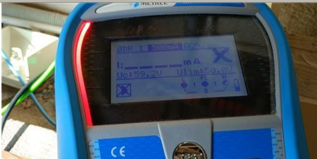
**Description :** Au moins un dispositif de protection différentielle ne fonctionne pas pour son seuil de déclenchement
